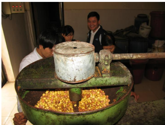
Hình 5. Ép nhân hạt chè để lấy dầu hạt chè và khô dầu (Ảnh Trần Đình Phả)
